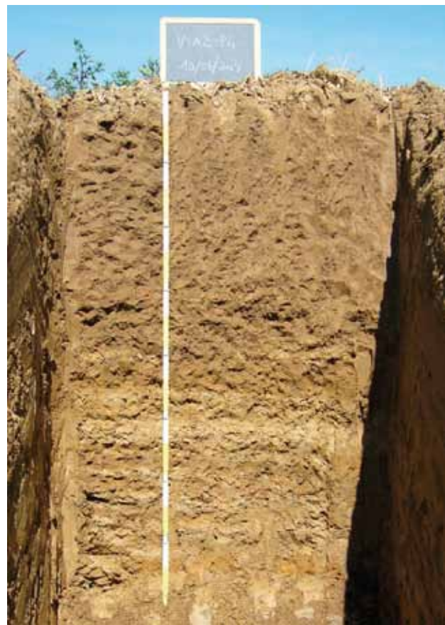
Fig. 1: Profilo n.4 in località Zerman: suolo limoso grossolano (Gleyic Calcisol) con diversi livelli di deposizione del carbonato di calcio in profondità (visibili tra 65 e 80 centimetri, quindi tra 90 e 93 e tra 98 e 105).
