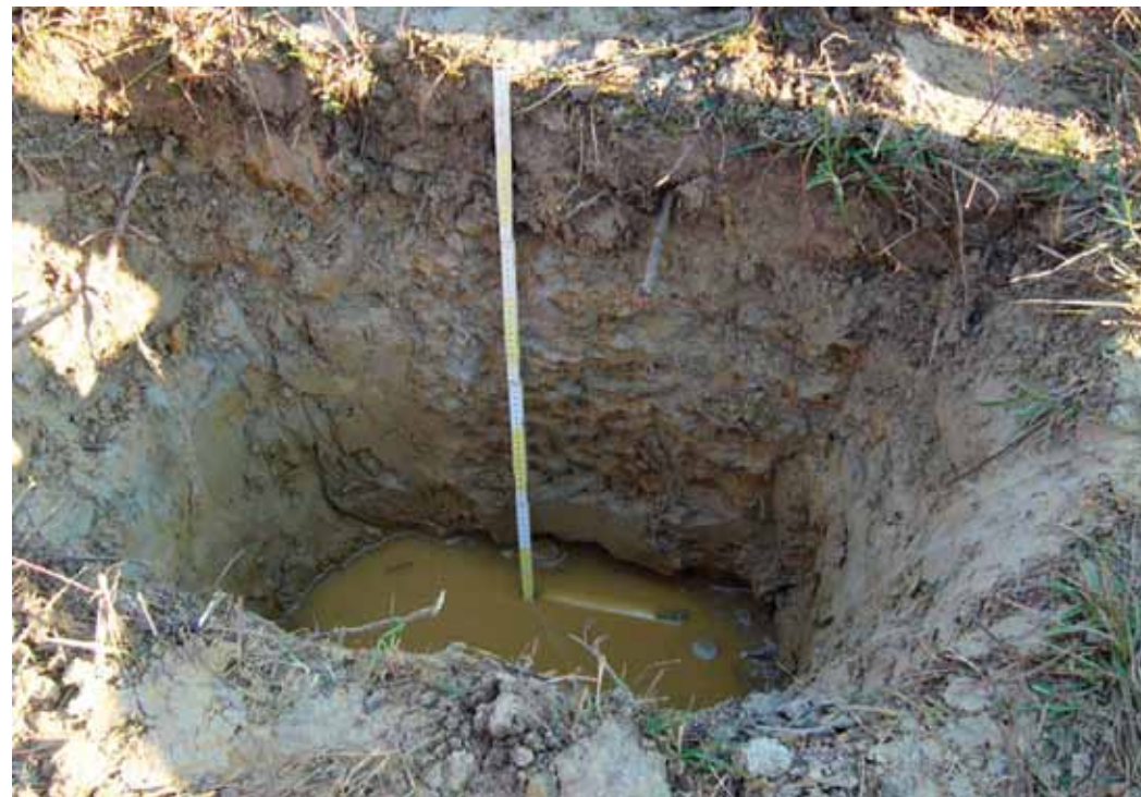
Fig. 10: Profilo 15: sono evidenti dai colori e dalla presenza della falda i problemi di idromorfia dei suoli dell'area delle ex cave Villetta
