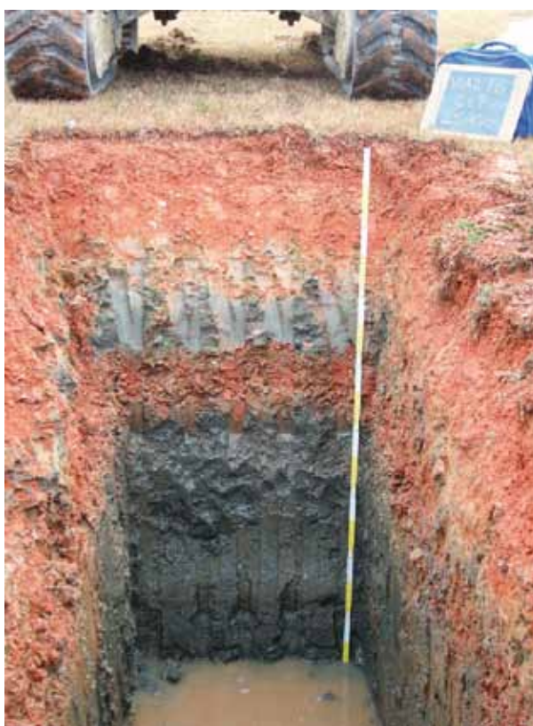
Fig. 7: Profilo 6: sono ben riconoscibili dal colore rosso gli scarti di laterizi usati per la ricomposizione dell'area cavata.
