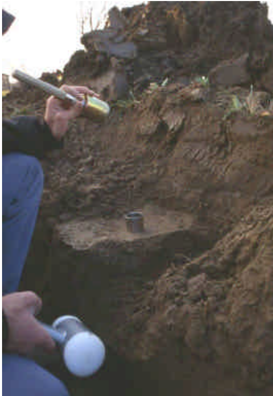
Figura 2: Prelievo di campioni indisturbati con il metodo del cilindretto per la misura di alcune caratteristiche fisiche.
